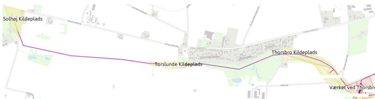
Figur 1: Oversigtskort over området med kildepladser og ledning. Ledningen fra Solhøj Kildeplads og til Værket ved Thorsbro er angivet med lilla streg mens kildepladserne er angivet med gul skravering. Området med Værket ved Thorsbro er angivet med rød skravering.
