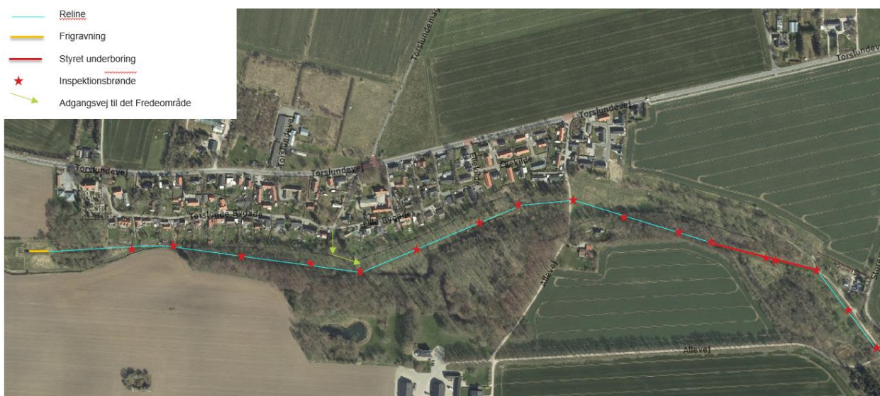
Figur 5 Omtrentlig placering af de gamle inspektionsbrønde (røde prikker) på råvandsledningen fra Torslunde Kildeplads og til Værket ved Thorsbro. Midlertidig adgangsvej angivet med neon-grønne pile.
